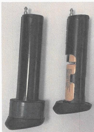
Ilustracja ZO3 - porównanie modułów zasilających TruCAM (po lewej) i TruSpeed (po prawej)
