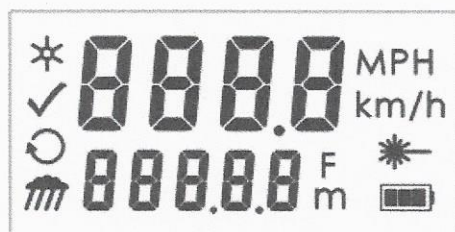
Ilustracja Z06 - zobrazowanie wyglądu wyświetlacza przyrządu TruSpeed z wyświetlonymi wszystkimi elementami
