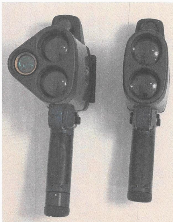
Ilustracja ZO1 - porównanie przyrządów TruCAM (po lewej stronie na obu zdjęciach) i TruSpeed (po prawej stronie na obu zdjęciach)
