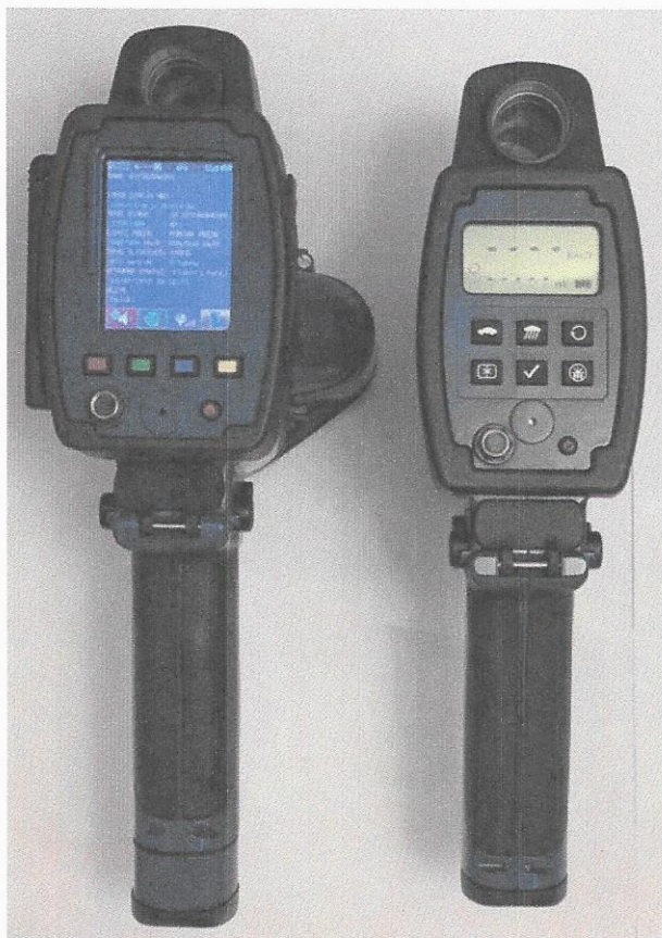
Ilustracja ZO1 - porównanie przyrządów TruCAM (po lewej stronie na obu zdjęciach) i TruSpeed (po prawej stronie na obu zdjęciach)
